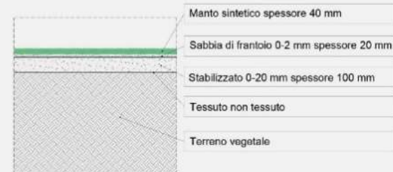
SEZIONE 2-2 - STRATIGRAFIA MANTO NUOVO CAMPO scala 1:20
