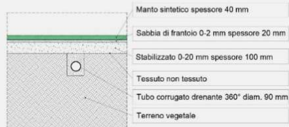
SEZIONE 1-1 - STRATIGRAFIA MANTO NUOVO CAMPO CON PARTICOLARE DEI DRENAGGI scala 1:20
